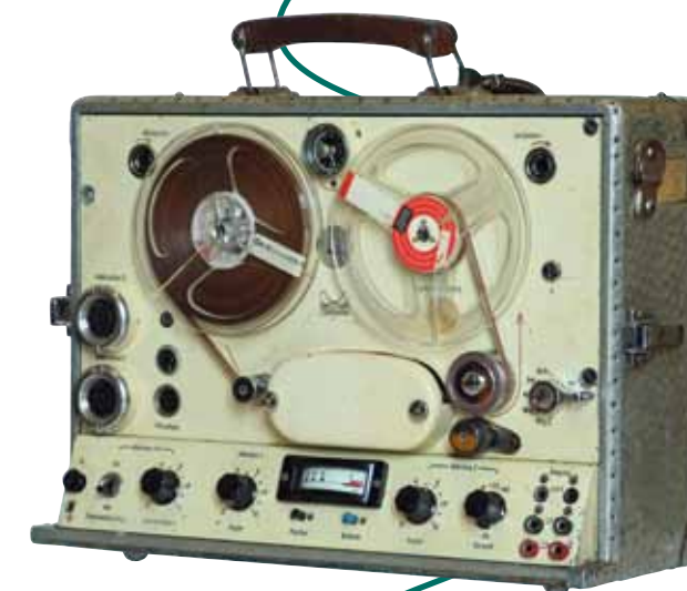
Maihak MMK6 Pilottonaufzeichnung mit Spulentonbandgerät
