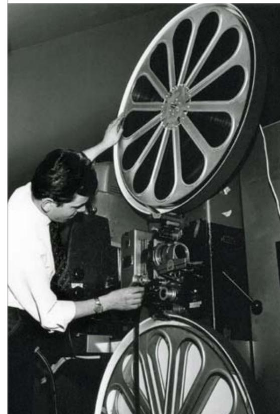
Grindel-Kino, 31.1.1963: Muskelkraft und Fingerspitzengefühl – die gewaltigen Cinerama-Filmrollen, in gesicherten Holzschubern geliefert, müssen von den Filmvorführern in alle drei Projektionsmaschinen gehoben und anschließend exakt eingelegt werden, um synchron zu laufen
