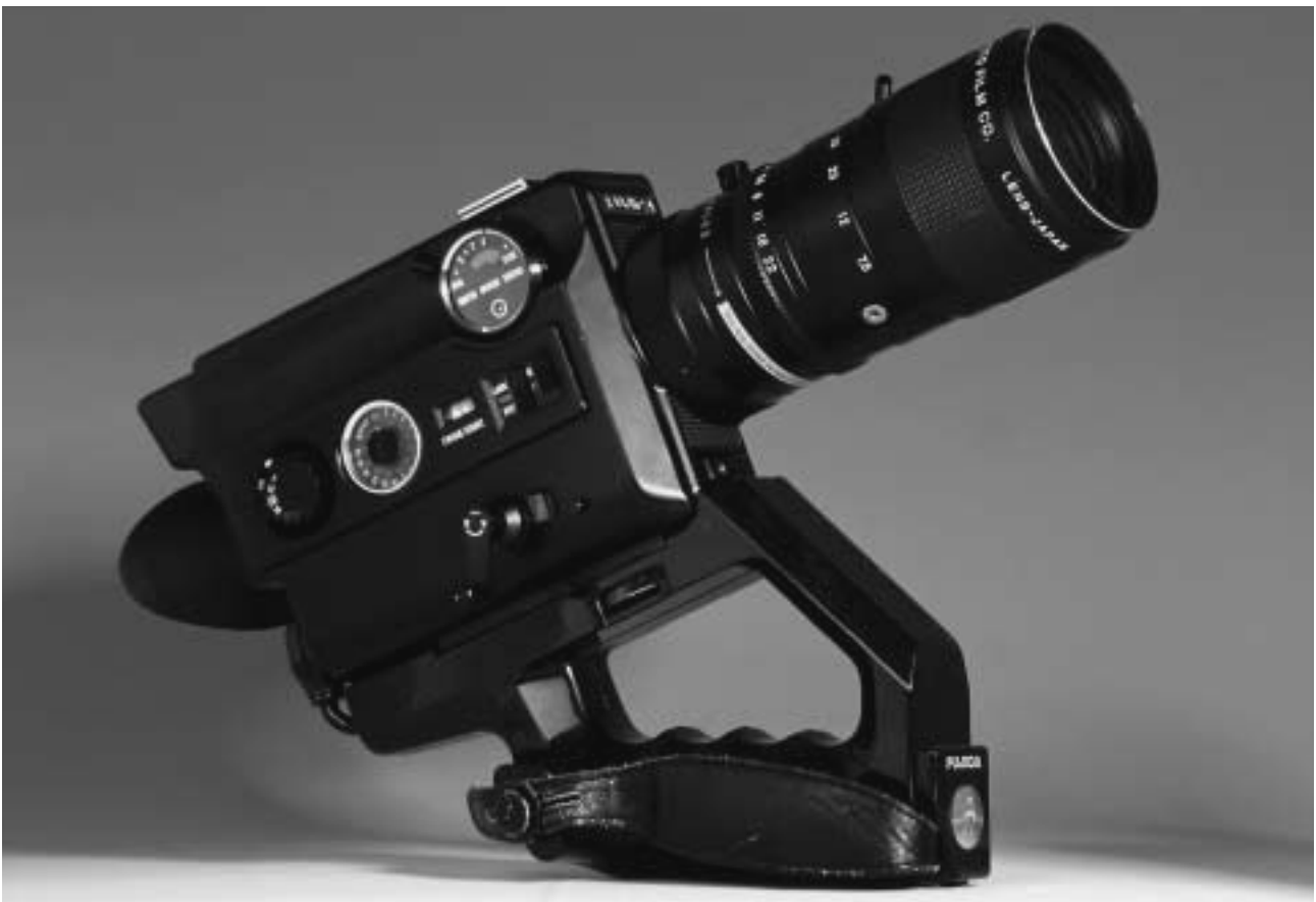
Spitzenmodell 1974: Fujica ZC1000 mit auswechselbarem Objektiv (C-Mount) und Schwingenspiegel. 100% Licht im Sucher und 100% Licht auf dem Film. (Fotos: Christian Mai)
